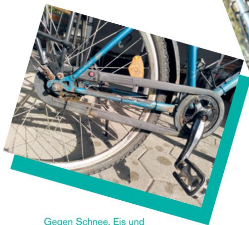
Gegen Schnee, Eis und Streusalz geschützter Antrieb durch Vollkettenschutz und Nabenschaltung
