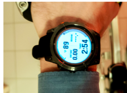
Der weiße Punkt auf dem schmalen Balken oben auf der Smartwatch zeigt ein sich näherndes Objekt.
